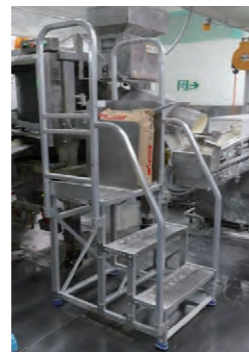
踏み台に手すり(名古屋工場)
