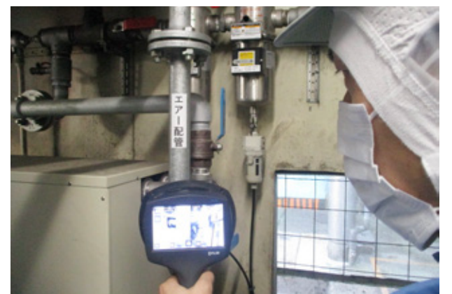
音響カメラを使用したエアリー漏れ点検の様子
