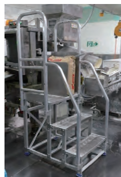
踏み台に手すり(名古屋工場)
