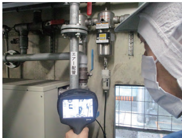
音響カメラを使用したエアリーク点検の様子
